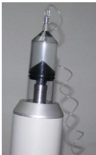
**Figura 4.10** – Conectar o tubo de ligação (extensor) e retirar o ar
