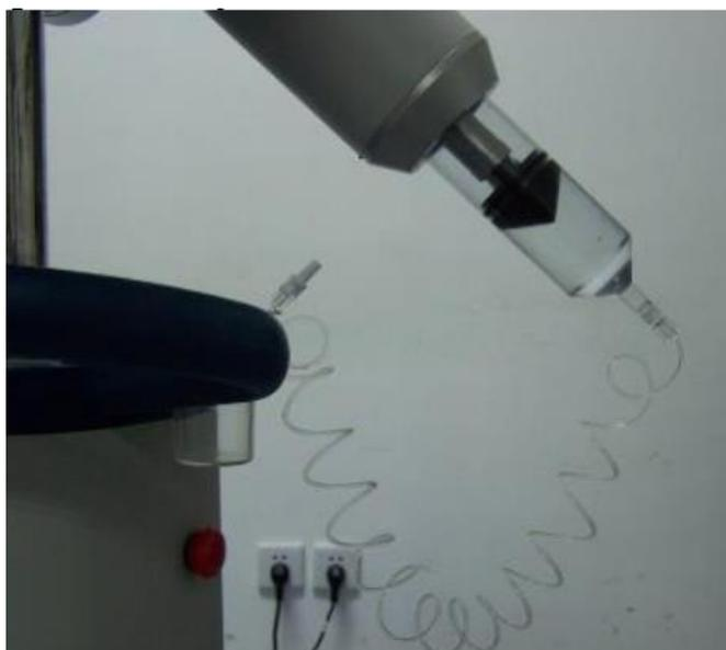
**Figura 4.11** – Coloque a cabeça da injetora para baixo e prepare para injeção
