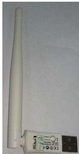
Fig.4-4 Adaptador de rede sem fio externo
