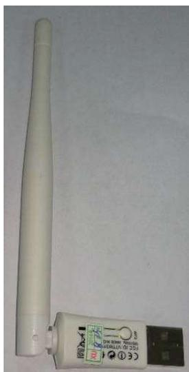
Fig. E-1 Adaptador Wireless Network externo (opcional)
