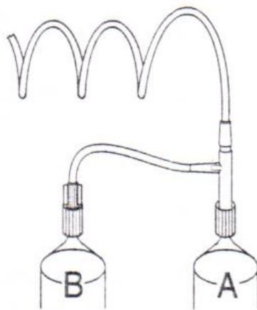
Figura 5.4 Instalação do tubo de conexão da seringa
