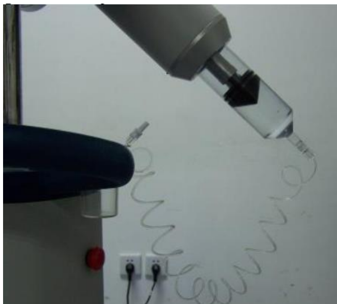
Figura 14 Coloque a cabeça da injetora para baixo e prepare para injeção
