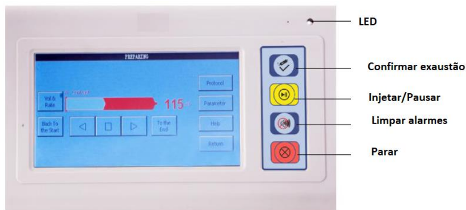
Figura 3 Console remoto e local
