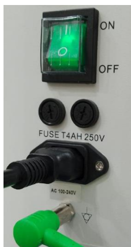
Figura 4 Ligando o interruptor de Energia
